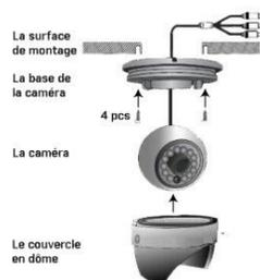
7. Pointer la caméra en dôme vers la position désirée. Tout en tenant la caméra sphérique en place, faire tourner le couvercle en dôme au maximum pour fixer la base de la caméra. Tenir la caméra permet de l'empêcher de bouger tout en serrant le couvercle en dôme.
